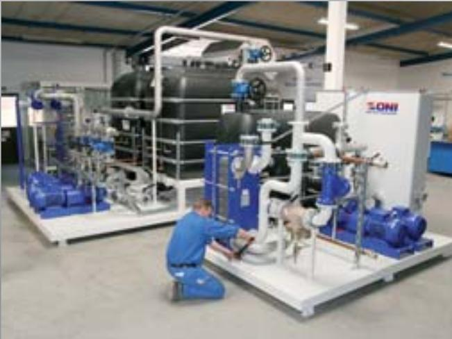
Endmontage einer modular aufgebauten Rückkühlanlage mit Rollbandfilter für einen Härtereibetrieb.
