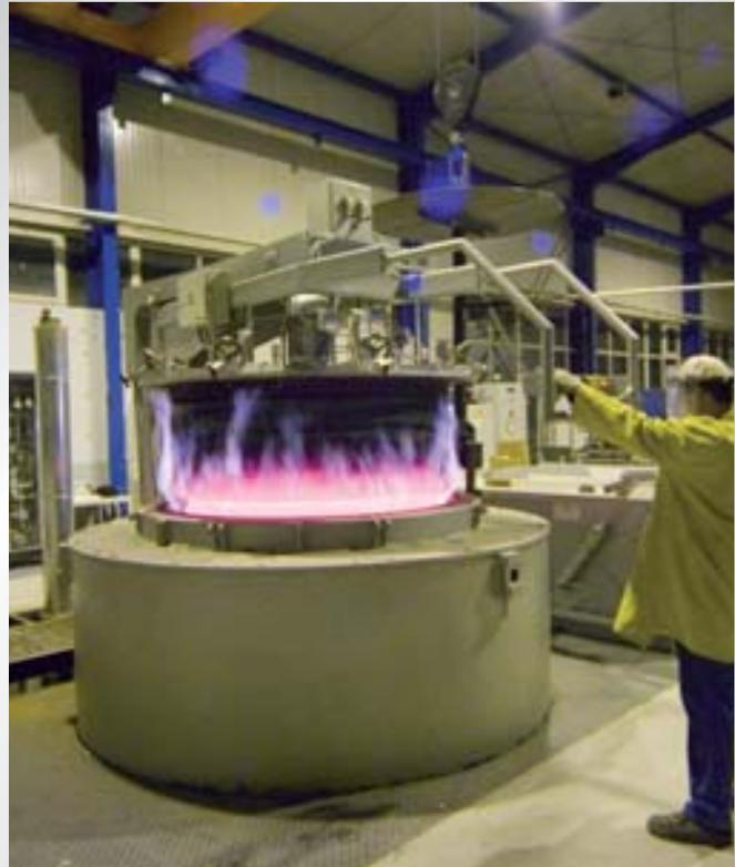
Ein Induktionshärteofen wird geöffnet. Die für den Betrieb erforderliche Kühlanlage kommt aus dem Hause ONI.
