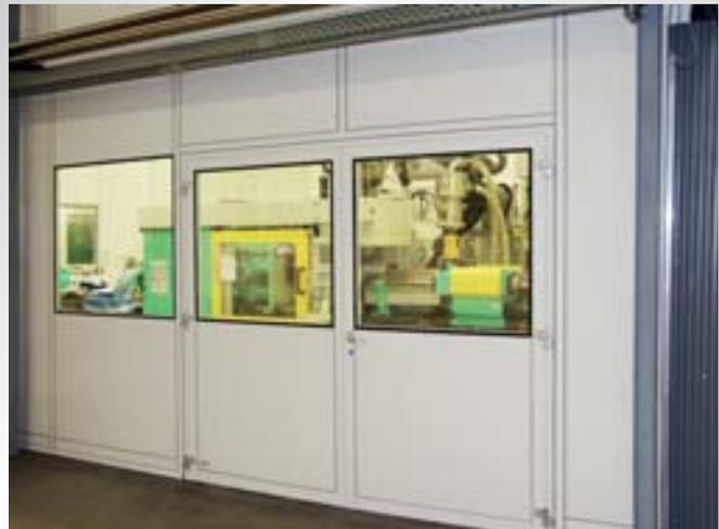
Blick in eine Reinraum-Fertigungshalle mit Spritzgussmaschinen; Reinraum-Klasse 100.000.
