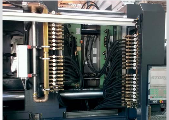
RHYTEMPER® FlowWatch, hier 40 Kreise in Werkzeugnähe integriert RHYTEMPER® FlowWatch, 40 circuits integrated near the moulds
