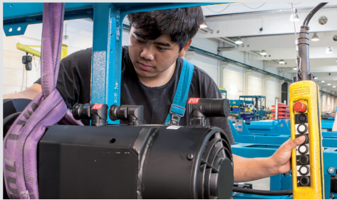
„Herz“ des BOY-Umspritzautomaten: Der energiesparende Servo-Antrieb
